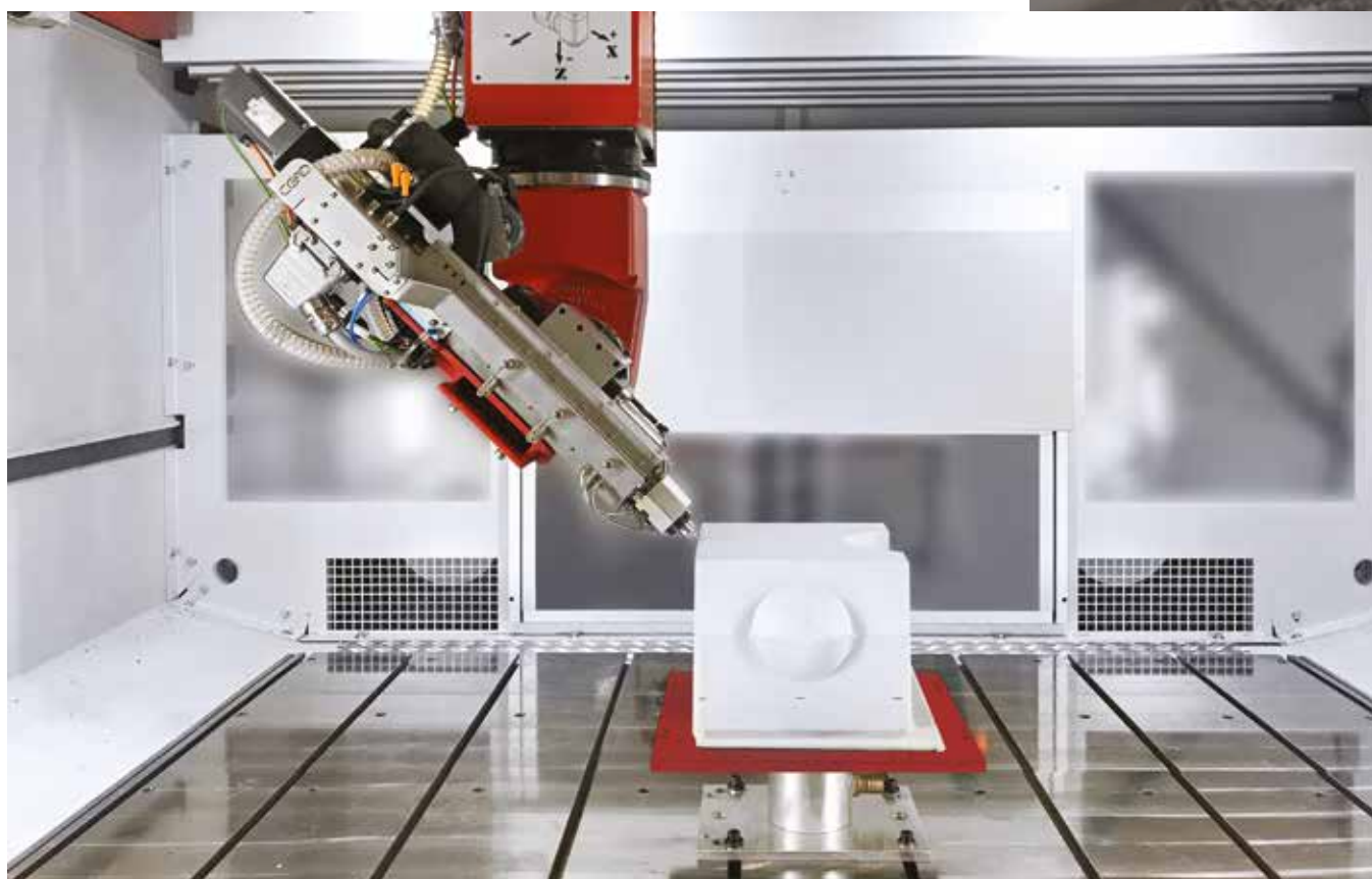
Stampa additiva con orientazione dell'estrusore a 45 gradi
